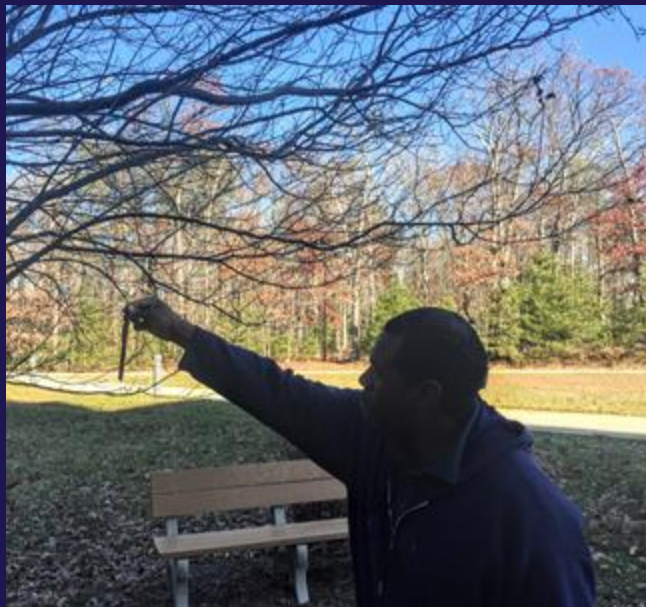
Ejemplos de cómo tomar la temperatura actual en la sombra: sostener un termómetro simple lleno de líquido en su sombra (izquierda) o apoyar un termómetro digital en un árbol (derecha). Crédito: GLOBE
