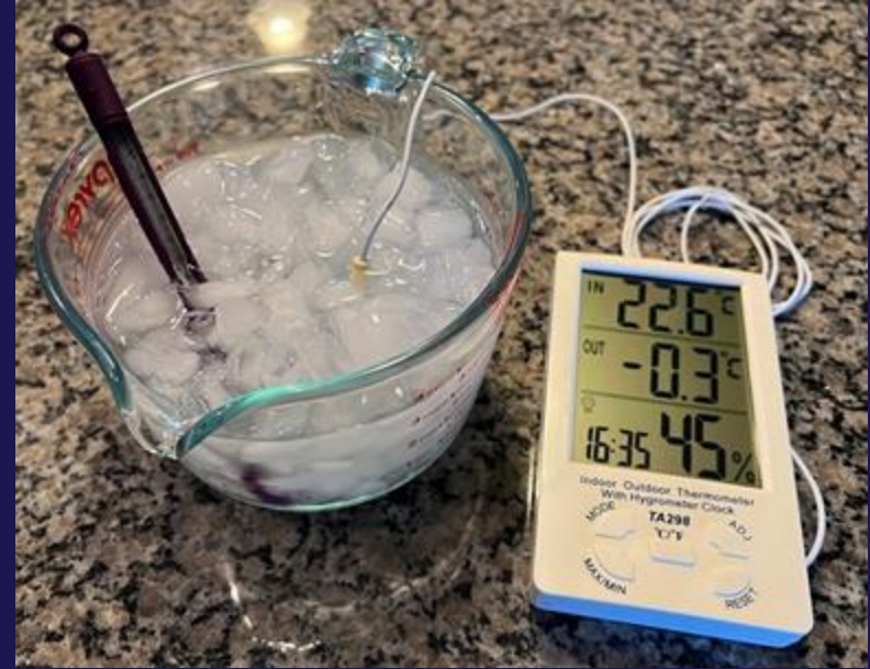
Probando la calibración de un termómetro lleno de líquido y un termómetro digital al mismo tiempo. Crédito: GLOBE
