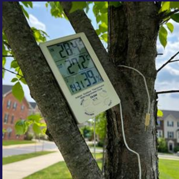
Ejemplos de cómo tomar la temperatura actual en la sombra: sostener un termómetro simple lleno de líquido en su sombra (izquierda) o apoyar un termómetro digital en un árbol (derecha). Crédito: GLOBE
